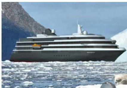
9.400 toneladas. Terá capacidade para 200 passageiros e 111 tripulantes. Estará equipado com um sistema de propulsão Rolls-Royce, terá uma velocidade de cruzeiro de 16 nós e casco e hélices reforçados para a navegação em gelo.
