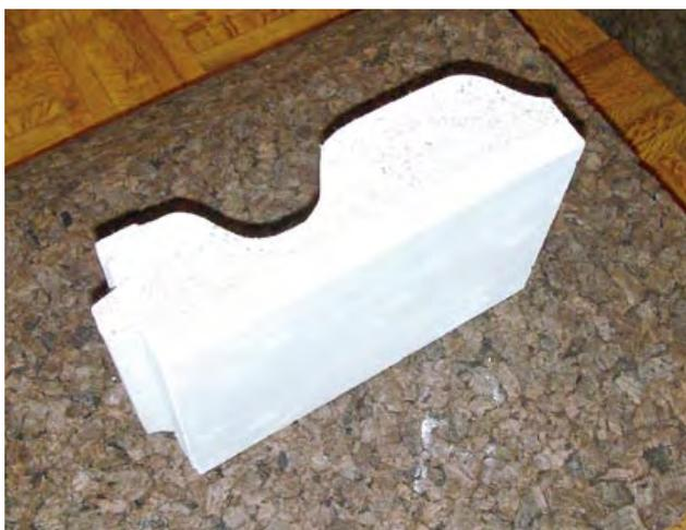
Figura 5 – Amostra (de cor branca) de aglomerado expandido de cortiça, gesso e fibras de pneus usados
