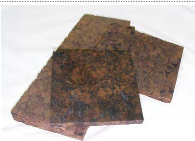
Figura 2 – Amostras de aglomerado expandido de cortiça densificado
