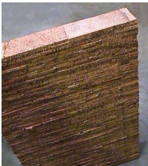
Figura 9 – Blocos de rolhas embaladas a vácuo e de lamelado colado de cortiça para calçado
