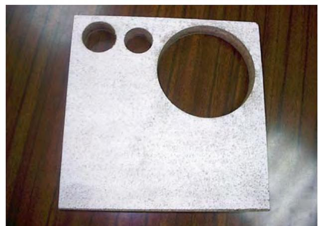
Figura 7 – Amostra de aglomerado de madeira pintado com tinta com incorporação com cortiça
