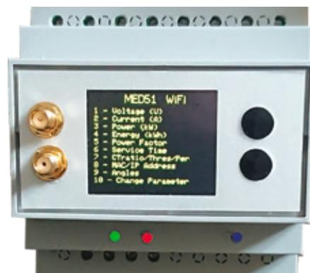
**Figura 2** Contador de Energia
