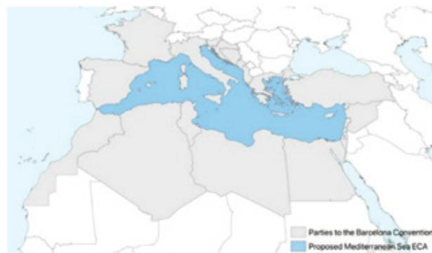
Os requisitos serão os mesmos das demais SECA, obrigando à utilização de combustível com teor de enxofre de 0,10% ou à instalação de um sistema de limpeza de gases de escape (*Exhaust Gas Cleaning System – EGCS*).
