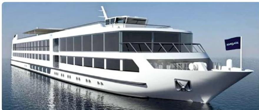
das com vista à redução da potência propulsora; foram instaladas duas colunas propulsoras azimutais de alto rendimento, cada uma com dois hélices contra-rotativos; foi instalada iluminação LED, o que permitiu uma poupança directa no consumo eléctrico de iluminação e uma poupança indirecta no consumo do ar condicionado; os vidros são atér-
