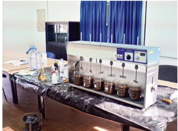
Figura 5 – Ensaio de Jar-test utilizado para simulação do processo físico-químico
