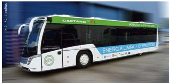
por 2500 EL, são alimentados por uma bateria de iões de lítio, com uma capacidade de 150 KWH a 400 V, dividida em sete módulos, com o peso total de 1800 kg e instalada nas paredes laterais do veículo. O tempo de carga da bateria é de 12 horas, com carregador de 10 Kw, ou de 4 horas, com carregador de 62 KW.
