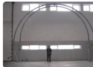
Modelos do suporte do Túnel do Rossio à escala natural, na sede da Fibersing (Porto)
