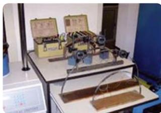
Primeiros modelos bidimensionais de suportes de túneis sujeitos a cargas concentradas
