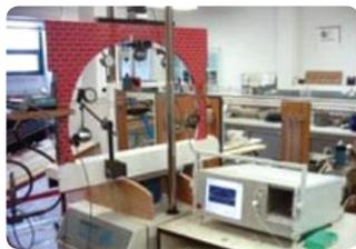
Ensaios sobre modelos reduzidos do Túnel do Rossio, com fibras ópticas
