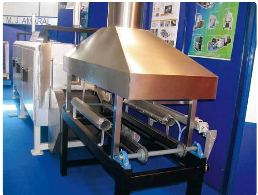
Fig. 5 – Forno contínuo protótipo de cinco secções, construído pela empresa M.J. Amaral
