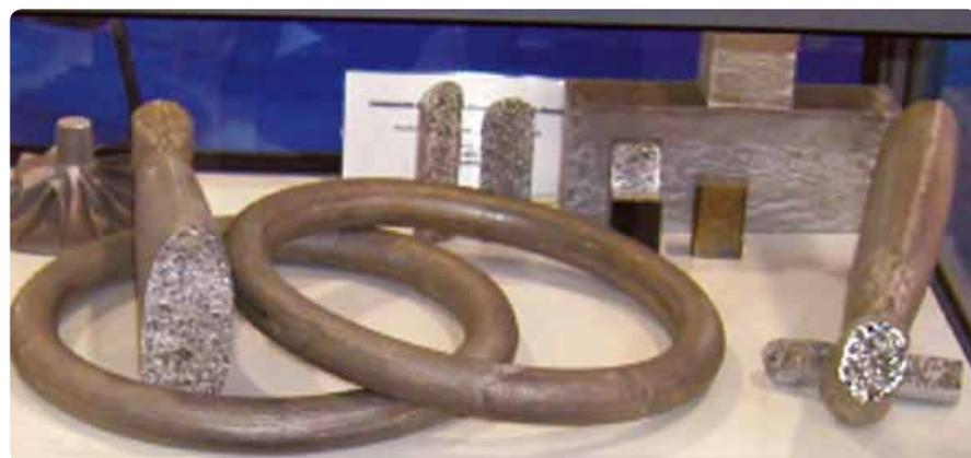
Fig. 6 – Componentes em espuma de alumínio fabricados no novo forno contínuo
