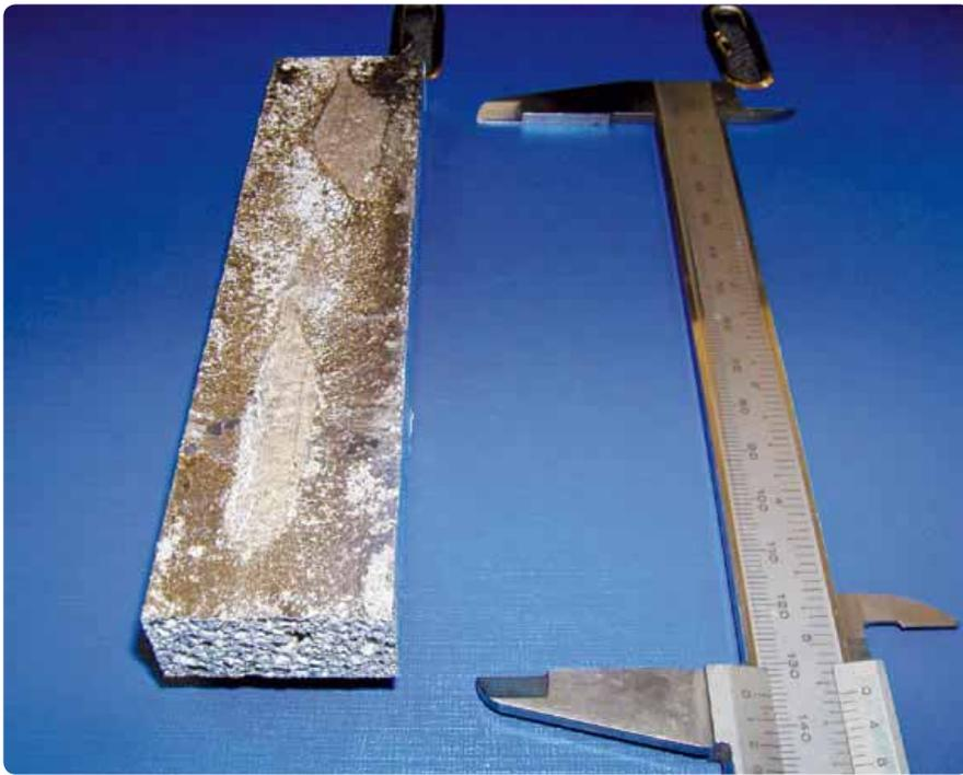
Fig. 4 – Componente em espuma de liga de alumínio
