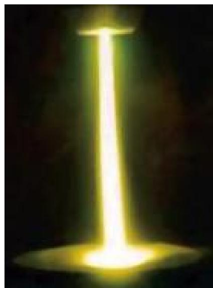
Figura 9 – Jacto de plasma emitido por uma tocha e que resulta de uma descarga eléctrica aplicada a um gás
