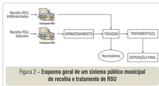
Figura 2 – Esquema geral de um sistema público municipal de recolha e tratamento de RSU
