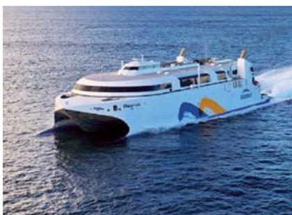
A principal inovação consiste na utilização de Gás Natural Liquefeito (GNL) ou diesel para abastecer duas turbinas a gás General Electric LM2500 com potência de 22 MW
