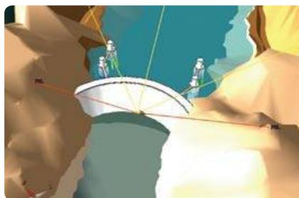
Aumento do número de sinais GNSS captados por um receptor situado a jusante, na base de uma barragem, em resultado da instalação de dois pseudolites
