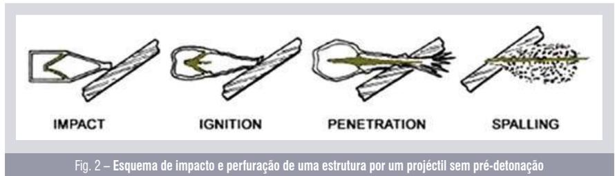
Fig. 2 – Esquema de impacto e perfuração de uma estrutura por um projectil sem pré-detonação
