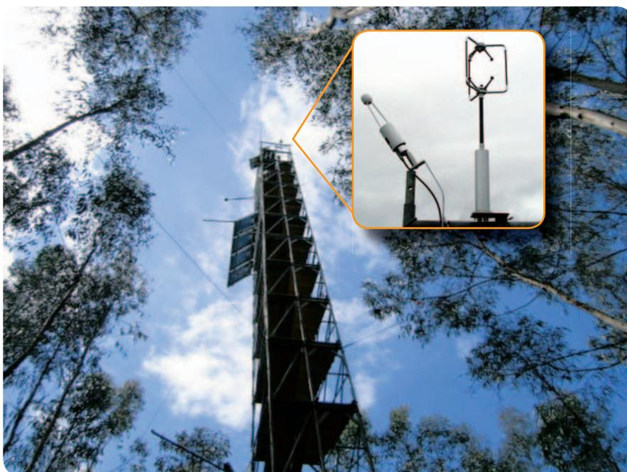
Figura 2 – Torre de 32 metros instalada num eucaliptal em Pegões. No topo está situado (a) um anemómetro sónico Gill® R2 acoplado a (b) um analisador de gases IRGA® Li – 7500 para medição das flutuações das concentrações de CO<sub>2</sub> e vapor de água
