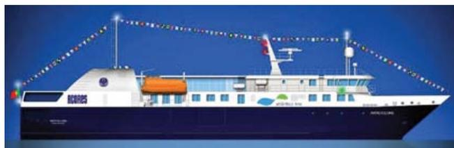
ter um comprimento de 71,3 m, 12,6 m de boca, 3,7 m de calado e uma velocidade de 17 nós, e que poderia transportar 375 passageiros e 30 viaturas.
