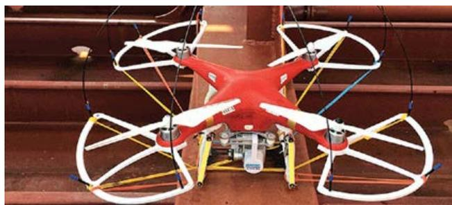
voou o drone necessita de aterrar e substituir a bateria, parcialmente devido ao consumo adicional dos projetores de iluminação. No futuro será necessário desenvolver e utilizar drones especializados que possam passar em pequenas aberturas e que possam ser transportados e operados por apenas um inspetor.
