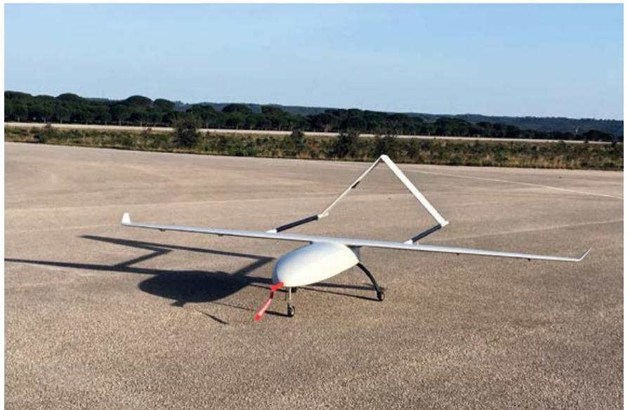
Figura 3 Gama "Wingo" com peso máximo à descolagem de 25kg
