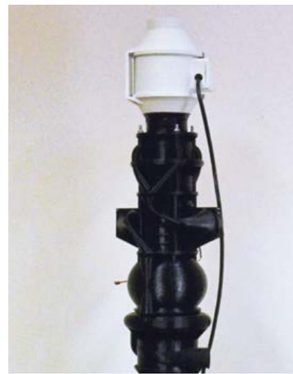
Figura 1 Prototipagem do sistema de tratamento de efluentes gasosos
