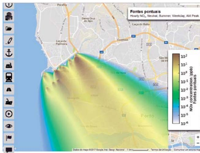
Figura 1 Concentrações horárias (ppb) simuladas de NO<sub>x</sub>, para o cenário de referência, obtidas da plataforma C-PORT avaliando a influência dos navios atracados nos terminais portuários
