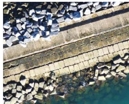
Figura 1 Detalhe de um ortomosaico de um quebra-mar gerado a partir de fotografias aéreas obtidas com um *drone*
