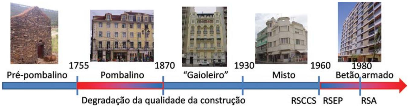
Figura 2 Evolução das tipologias construtivas e dos regulamentos de dimensionamento sísmico. A vermelho indicam-se os períodos em que houve preocupação relativamente à resistência sísmica dos edifícios, ou seja, no período de reconstrução da baixa pombalina, na sequência do sismo de 1 de novembro de 1755, e a partir da introdução de regulamentação sísmo-resistente em Portugal
