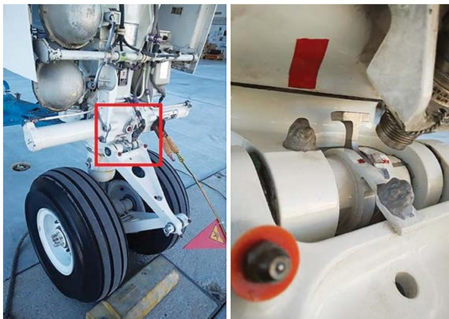
Figura 2 Troubleshooting de falha no trem de aterragem: análise de funcionamento do sensor de proximidade do trem de nariz
