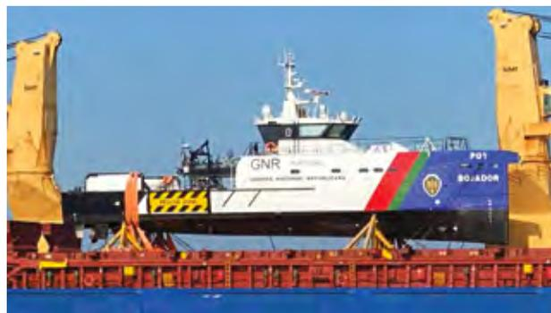
junto de quatro lanchas, tendo custado cerca de 8,5 milhões de euros, subsidiados a 75% por fundos europeus. Esta lancha surpreende pelas suas dimensões significativas, pois possui quase 35m de comprimento fora a fora, boca de 7,35m e calado de
