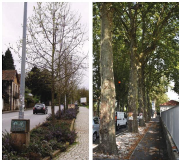
Figura 1 **Faixas verdes que oferecem uma proteção não só psicológica, mas também física. Em Vila Real (foto de 2008) a faixa tem arbustivas pouco exigentes em água. A passagem pedonal em calçada portuguesa permeável permite também a expansão das raízes. Em Riba de Ave (Vila Nova de Famalicão) foi convertida uma área de passeio sem uso pelo peão**
