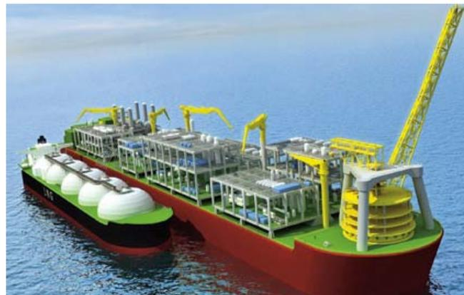
de emergência. O navio-tanque para transporte de produtos condensados irá amarrar à popa do FLNG, sendo o transbordo efectuado segundo as práticas correntes nas instalações FPSO.
