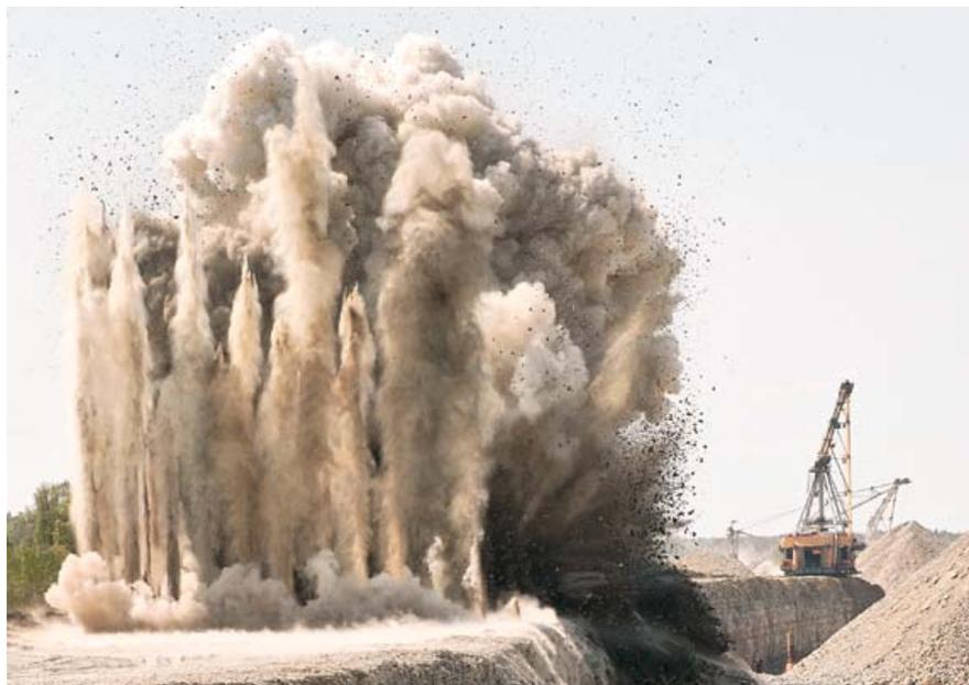
Após o levantamento das condições anteriormente descritas, foi elaborado o cálculo Diagrama de Fogo Tipo (geometria e carregamento), tendo em consideração o tipo de zona(s) (condicionada ou não condicionada), tendo sempre em conta os limites de vibração legalmente impostos (NP 2074 de 1983), bem como a correcta selecção do equipamento de perfuração.
