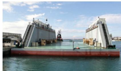
enchimento dos tanques de lastro por gravidade e de subida por meio de bombas de esgoto submersíveis. O casco foi construído na Ucrânia, tendo o aprestamento sido realizado em Peniche, conforme é frequente na construção naval dos nossos dias.
