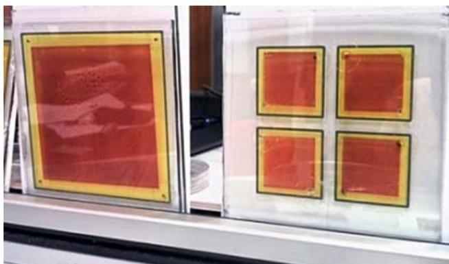
Dye-Sensitized Solar Cells (DSC) – que transformam energia solar em energia elétrica – ao desenvolver um novo modelo de encapsulamento que aumenta, significativamente, a longevidade deste tipo de células
