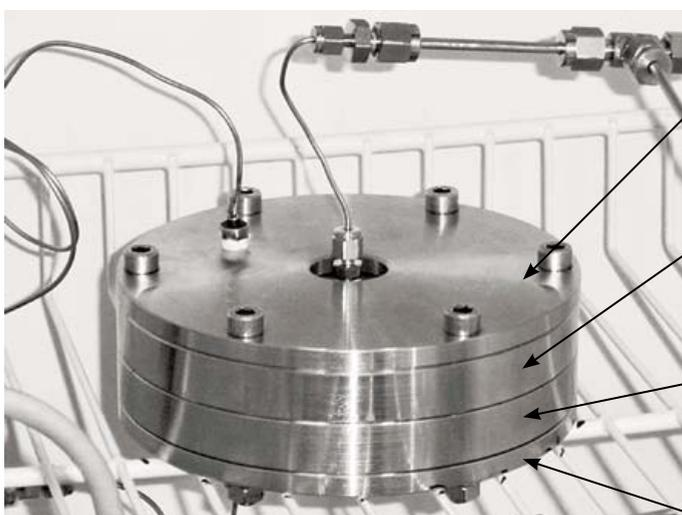
Figura 4 – Célula de permeação utilizada na determinação da permeabilidade ao dióxido de carbono
