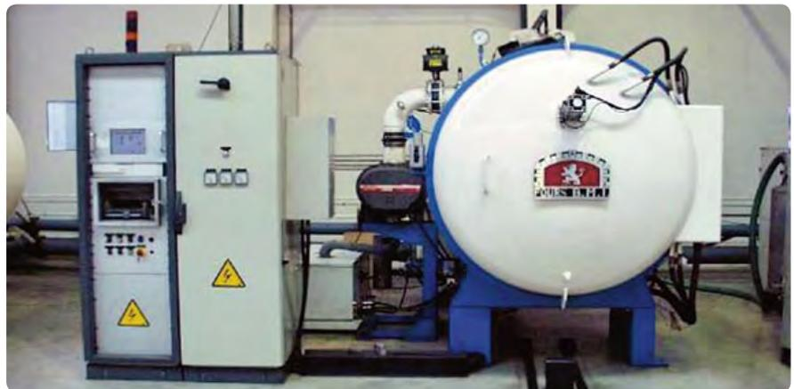
Fig. 5: Equipamento de Nitruração em vácuo
