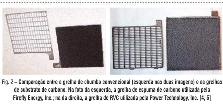
Fig. 2 – Comparação entre a grelha de chumbo convencional (esquerda nas duas imagens) e as grelhas de substrato de carbono. Na foto da esquerda, a grelha de espuma de carbono utilizada pela Firefly Energy, Inc.; na direita, a grelha de RVC utilizada pela Power Technology, Inc. [4, 5]
