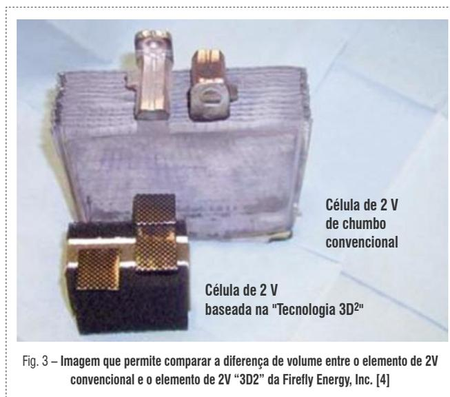
Fig. 3 – Imagem que permite comparar a diferença de volume entre o elemento de 2V convencional e o elemento de 2V “3D2” da Firefly Energy, Inc. [4]
