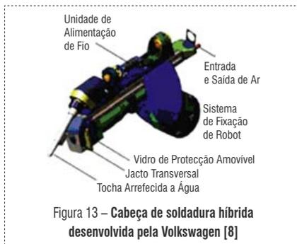
Figura 13 – Cabeça de soldadura híbrida desenvolvida pela Volkswagen [8]
