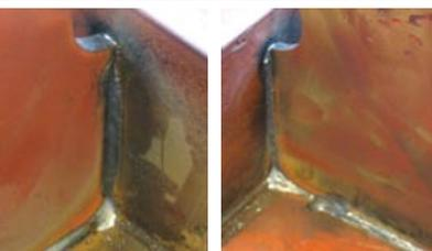
Figura 11 – Painéis soldados com o processo híbrido evidenciando a ausência de distorções [9]
