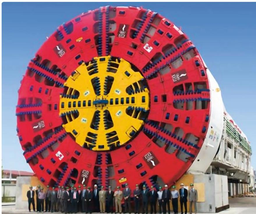
Figura 2 – Frente do escudo de uma tuneladora
