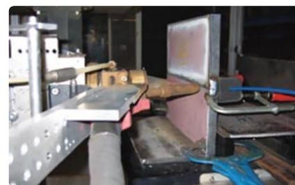
Figura 8 – *Set up* para soldadura laser com MIG em construção naval [11]
