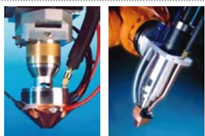
Figura 12 – Cabeças de soldadura integradas para processos híbridos [8]
