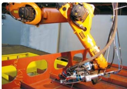
Figura 10 – Set up para soldadura híbrida laser com MAG usada em construção naval [9]
