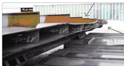
Figura 7 – Painel soldado para barco de passageiros evidenciando as distorções devidas às operações de soldadura [11]
