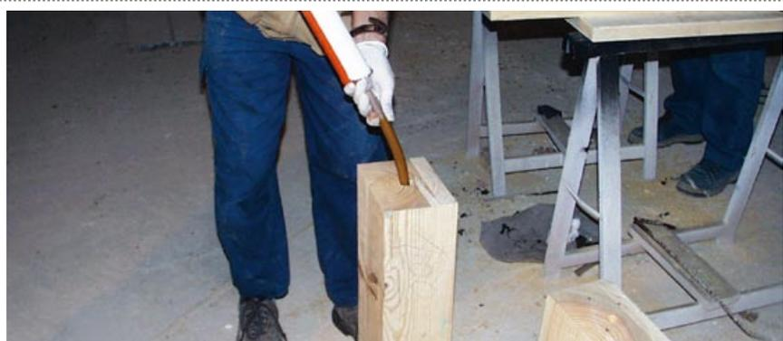
Figura 1 – Prova prática de qualificação de um carpinteiro com treino específico para aplicação de produtos poliméricos e FRP (polímeros reforçados com fibras). Durante esta prova o carpinteiro deve demonstrar proficiência no manuseamento dos equipamentos e produtos utilizados em diversas técnicas de reabilitação de estruturas de madeira.
