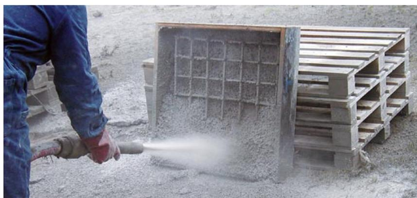
Figura 2 – Prova prática de qualificação de um operador de equipamento de projecção de betão. Durante esta prova o operador deve demonstrar proficiência na projecção de betão em aplicações estruturais. O painel projectado é, mais tarde, carotado, para verificar o adequado envolvimento das armaduras pelo betão projectado.
