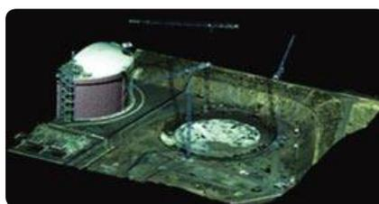
coordenou, em fase de projecto, uma equipa multidisciplinar que, de forma articulada, aplicou várias técnicas raramente reunidas, incluindo levantamentos aero-fotogramétricos, topográficos, detecção de estruturas enterradas por geo-radar e simulação de im-
