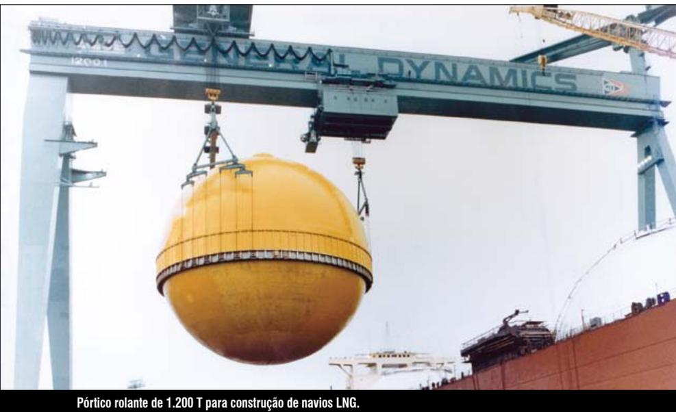
Pórtico rolante de 1.200 T para construção de navios LNG.
