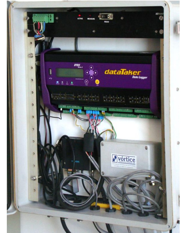
Consola de registo e transferência dos dados maregráficos
