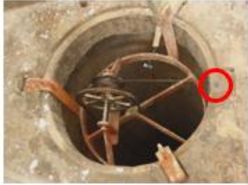
R1B - Marca de contacto do poço do Marégrafo Analógico
