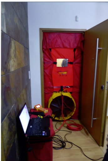
Blower door test
