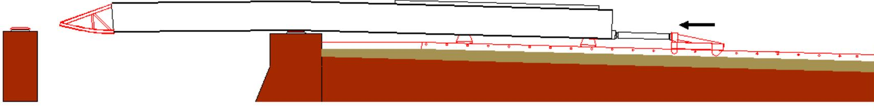
**Remoção da fixação da cadeira e avanço da mesma por acção do fecho do cilindro hidráulico.**
