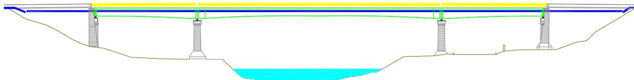
Desmontagem do tramo central antigo, pilares provisórios e pórticos.
