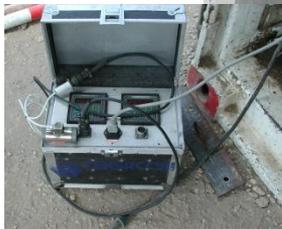
Ancoragem no encontro. Um dos cordões tem instalado uma célula de carga para monitorização do tirante.
