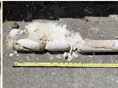
Constituição do interior das paredes
