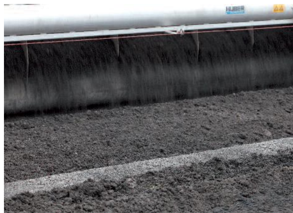
Mistura e arejamento das lamas por meio do revolvedor
